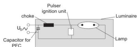
OPERATION OF HIGH INTENSITY DISCHARGE LAMPS WITH PULSE IGNITION UNIT
