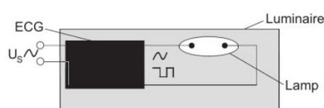
ELEKTRONIC OPERATION OF HIGH INTENSITY DISCHARGE LAMPS
