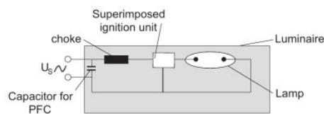
OPERATION OF HIGH INTENSITY DISCHARGE LAMPS WITH A SUPERIMPOSED IGNITION UNIT
